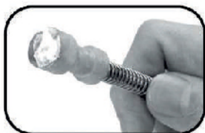
Figura 2 - Modo de aplicação da pasta no sensor
